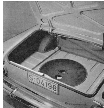
Eingelassen in den Boden des Kofferraums ruht das Reserverad. Damit ist eine optimale Nutzung des Kofferraumes gewährleistet.
